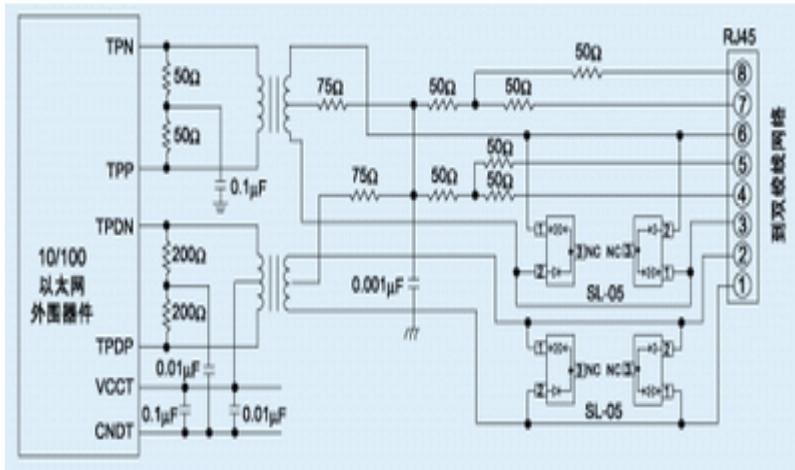
处理瞬时脉冲对器件损害的最好办法是将瞬时电流从敏感器件引开。TVS二极管在线路板上与被保护线路并联，工作原理(当瞬时电压超过电路正常工作电压后，TVS二极管便发生雪崩，提供给瞬时电流一个超低电阻通路，其结果是瞬时电流通过二极管被引开，避开被保护器件，并且在电压恢复正常值之前使被保护回路一直保持截止电压。)当瞬时脉冲结束以后，TVS二极管自动回复高阻状态，整个回路进入正常电压。许多器件在承受多次冲击后，其参数及性能会发生退化，而只要工作在限定范围内，
