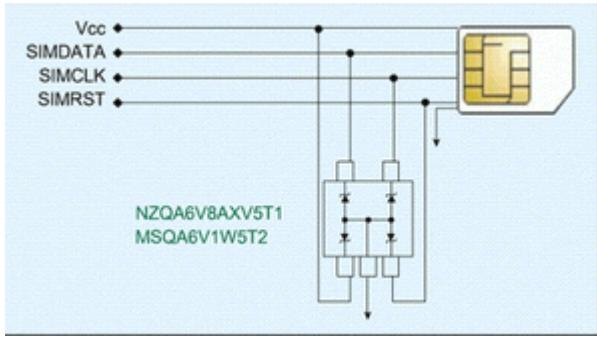
脉冲波形、持续时间和环境温度有关。而且，TVS 所能承受的瞬态脉冲是不重复的，器件规定的脉冲重复频率(持续时间与间歇时间之比)为 0.01%。如果电路内出现重复性脉冲，应考虑脉冲功率的累积，有可能损坏 TVS。
