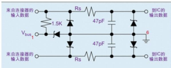
品都带 4 个单相独立线路 ESD 保护，其中 MSQA 系列、NSQA 系列和 SMF05 的封装形式是 SC-88A，NZQA 系列的封装形式是 SOT-553。其中 NZQA5V6XV5 是 5.6V 单向式 TVS 保护器件；NZQA6V2XV5 是 6.2V 单向式 TVS 保护器件；NZQA6V8XV5 是 6.8V 单向式 TVS 保护器件；NZQA6V8AXV5 是 6.8V 单向式、低电容 TVS 保护器件；NUP4102XV6 是 14V 双向式、低电容 TVS。这些 SOT5xx 封装的 TVS 器件均针对 260°C 回焊温度处理工艺生产，符合 100% 无铅和静电放电保护的要求，比传统的 SC88 封装减少电路板空间达 36%，降低厚度 40%，适合用于对电路板空间要求严格的便携设备，如手机、数码相机、MP3 播放器。
